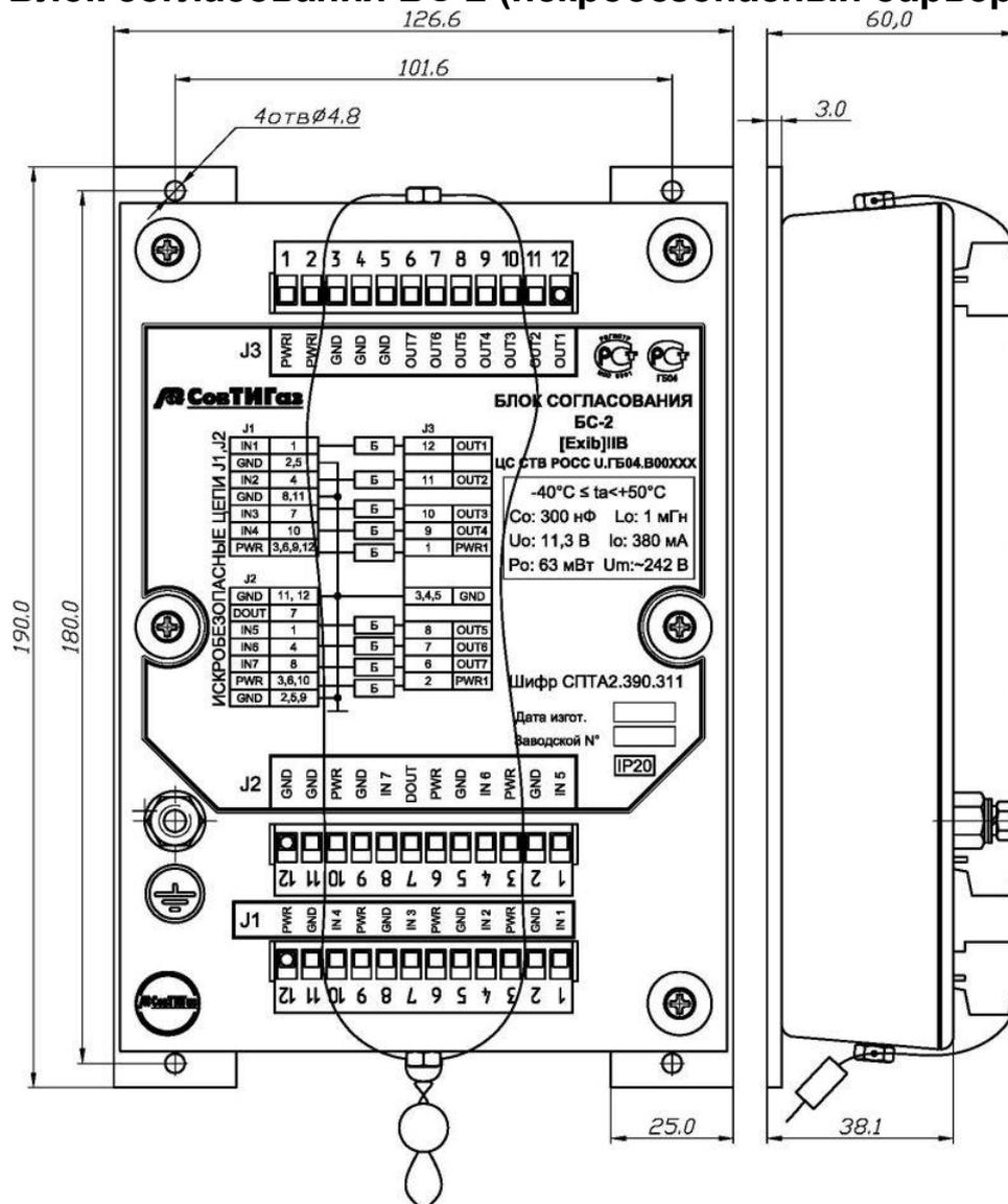
Предназначен для создания искробезопасных цепей и электрического сопряжения оборудования, расположенного в невзрывоопасной зоны с оборудованием, расположенным во взрывоопасной зоне, в которой возможно образование взрывоопасных смесей категорий IIA и IIB групп T1, T2, T3.
